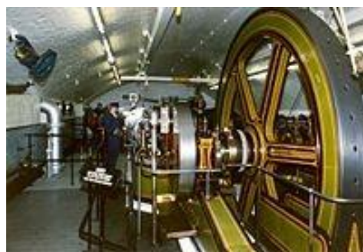
Expozice s původním parním strojem, dříve zvedajícím most
